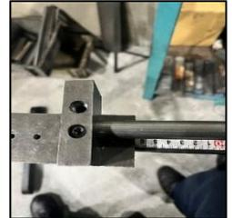
②丸パイプの斜切り後、エグリ加工をセットする時に、鈍角(86度)すぎて、ねじれないように合わせるのが大変だったが、専用の治具を作成して簡単に合わせられるようにしました。by武田勇・上岡浩二・黒田巧
