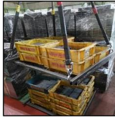
①今までは、製品を入れた専用箱を1個ずつトラックに手で積んでいたが、専用台を作成して、クレーンでまとめて積めるようにしました。体への負担軽減にもなりました。by佐多良太
