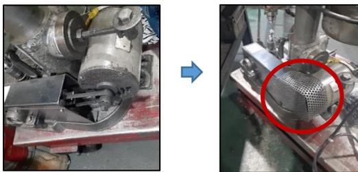
①面取り機の回転部分が露出していた。巻込事故防止のため、カバーを設置しました。by西井豊・カオグエントウアンホア
