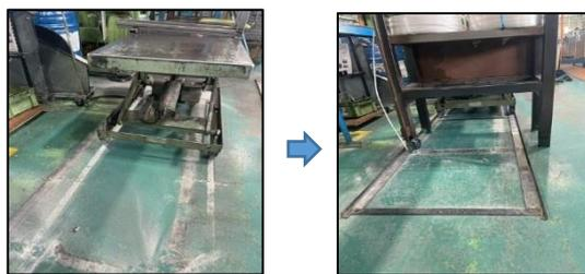
②昇降台車の移動用レールの使い勝手がイマイチだったので、レールの位置を変え、レールガイドを付けました。by武知伸一・中川誠・ファムミンファップ
